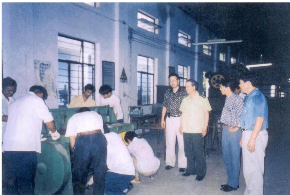
图 2 浙江义乌消防器材厂 1211 灭火器生产设备拆除
