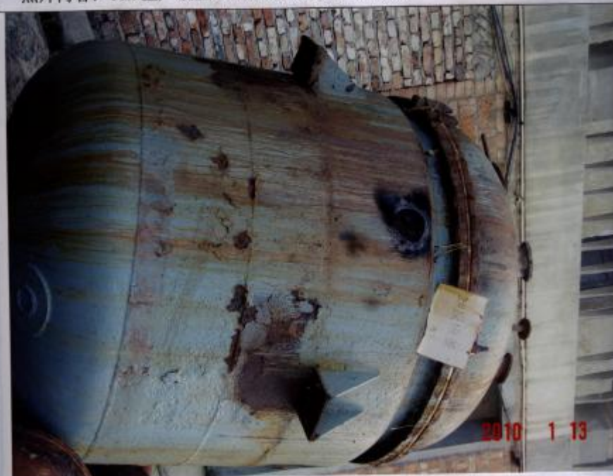
照片内容：TCA 生产装置 2#反应釜切割捣毁后照片
